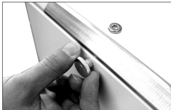
2. Odkręć ręką wszystkie osiem śruby mocujące drzwiczki.
