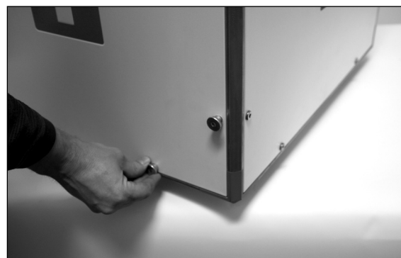
8. Wreszcie przykręć drzwiczki używając 8 dużych śrub, wkręcanych ręką.
