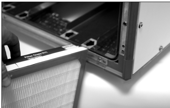
5. Upewnij się, że filtry zostały prawidłowo włożone zgodnie z naklejkami na filtrach o przepływie powietrza.
